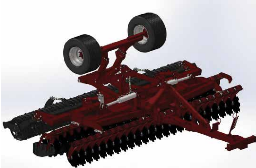
5. ábra Az új fejlesztésű variábilis rövidtárcsa 3D digitális modellje
