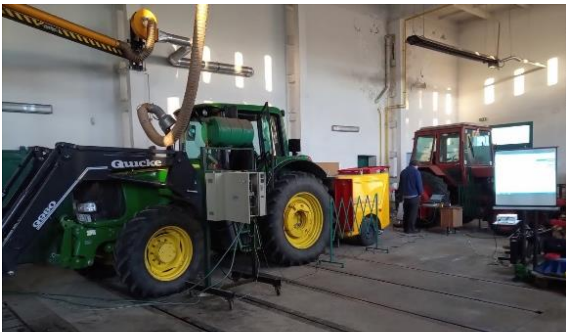
4. ábra. Traktormotor üzemi jellemzőinek vizsgálata TLT fékezéssel
