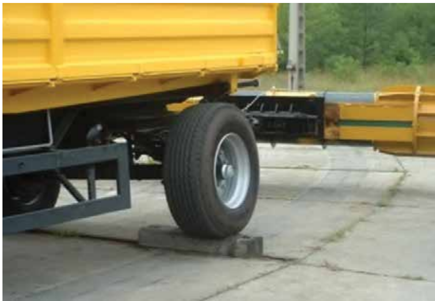
6. ábra. Vágóasztal szállítókocsi és pótkocsi fárasztópályás vizsgálata
