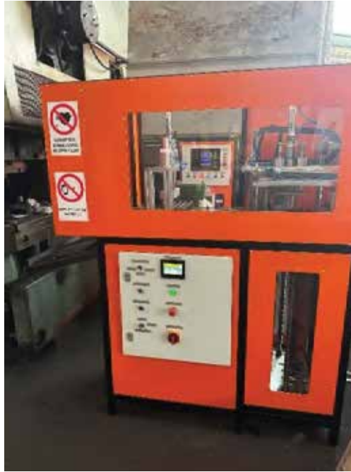
6. ábra Az indukciós hevítő berendezéssel pontos hőkezelést tudnak végezni.
