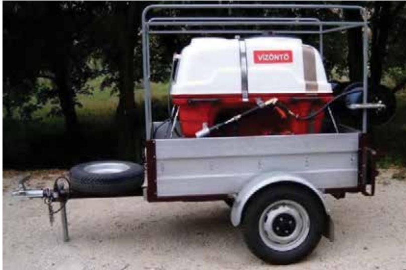
24. ábra. VÍZÖNTŐ erdőtűz-oltó berendezés (fotó: Horváth B.)
