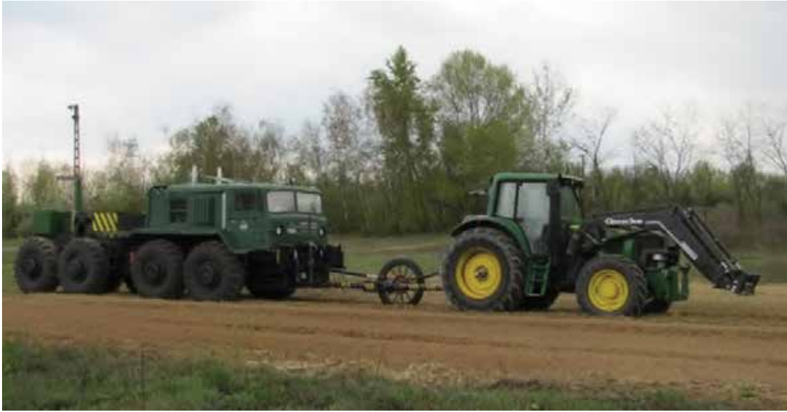
5. ábra. Traktorok vontatási jellemzőinek vizsgálata fékkocsival
