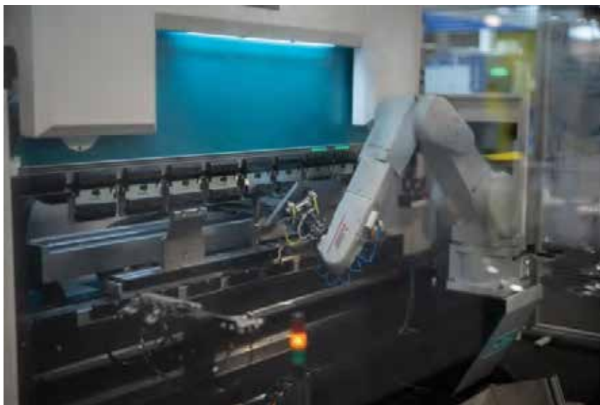
6. ábra A PMT Zrt. „PMroboT” robotos automatizált élhajlító cellája üzemi állapotban
