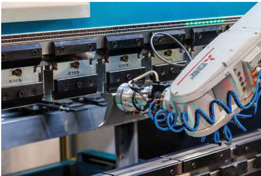
7. ábra Az élhajlító gépre felszerelt robot a gripperrel (robotos szerszám megfogóval)
