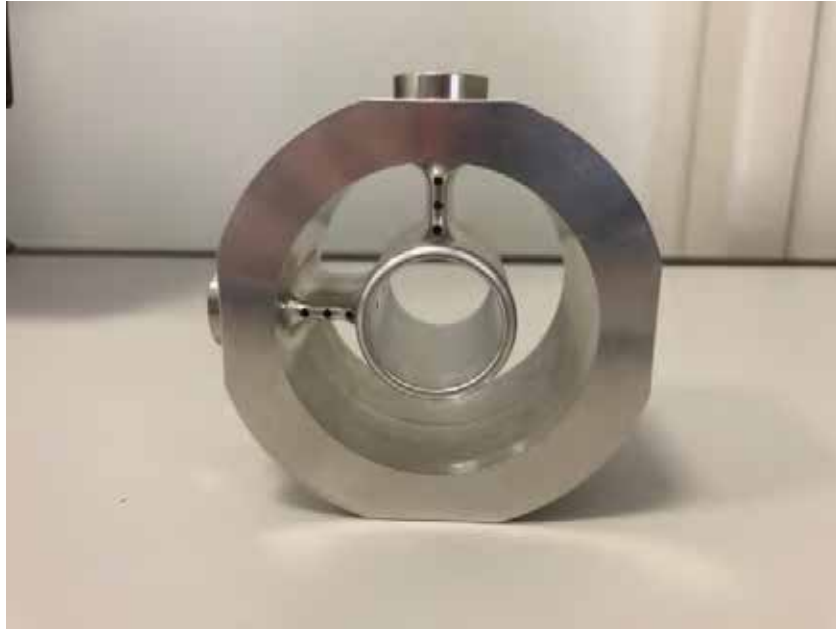
1. ábra: A kifejlesztett nyitott fotó-akusztikus kamra
